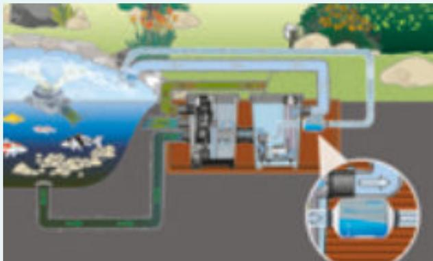
2. Instalación con un sistema de filtración por presión. Es necesario una segunda bomba para evitar la pérdida de presión.
