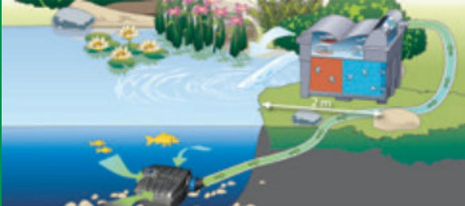
Ejemplo de instalación: BioSmart UVC 16000 en combinación con bomba de filtración y arroyos AquaMax Eco Classic
