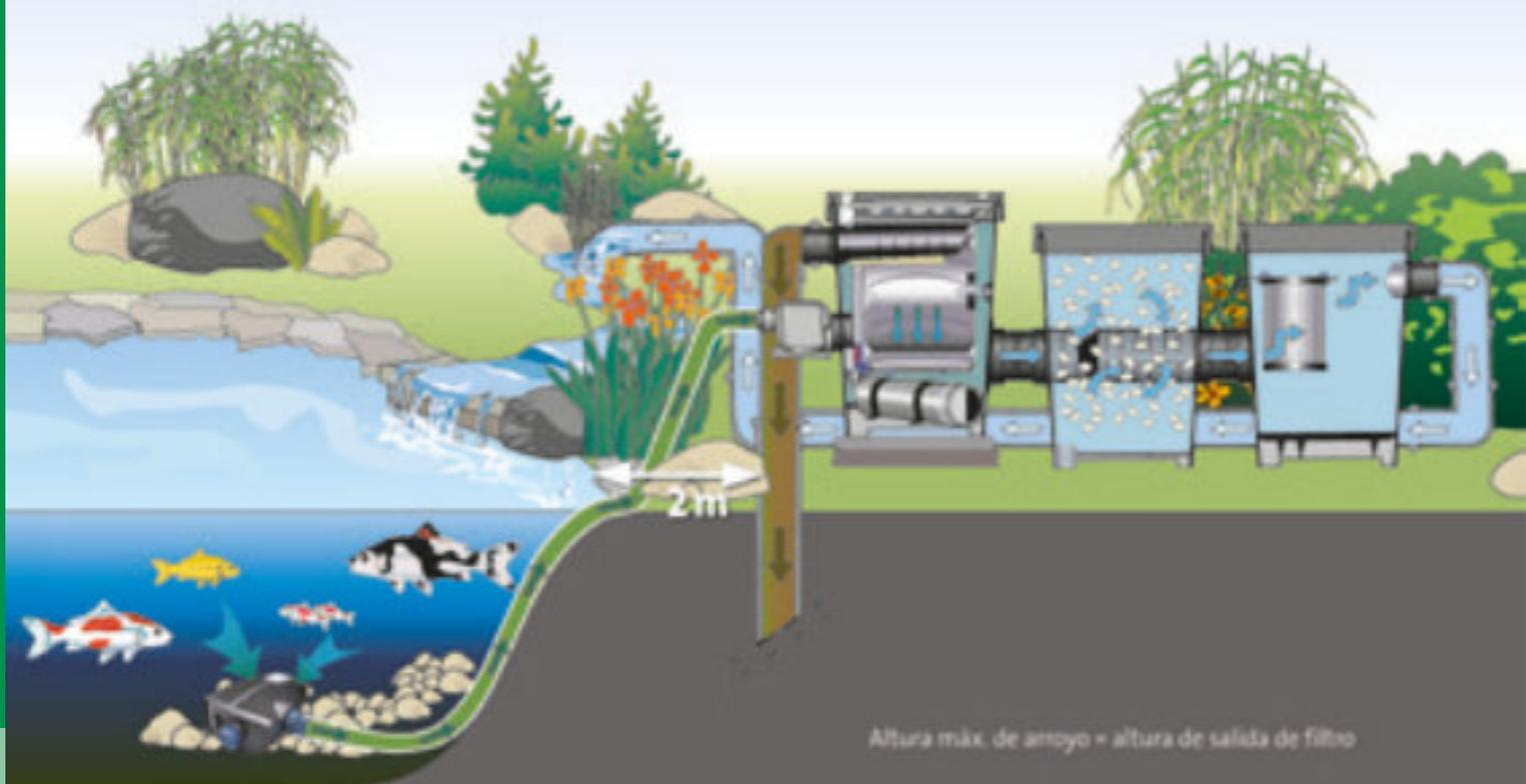
El sistema de filtración modular ProfiClear, puede ser instalado de dos maneras diferentes, dependiendo de las condiciones del lugar: Sistema por gravedad o sistema por bombeo
