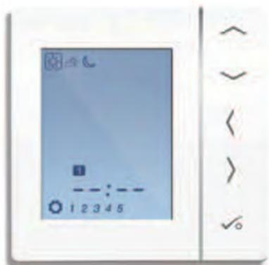
Repetir en el periodo 2 seleccionando hora y modo de funcionamiento deseado. ☀️ ☁️ 🌙
